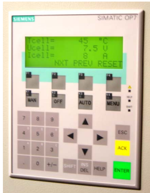
Große, 4-zeilige Anzeige der Steuerungs- und Kontrolleinheit.
