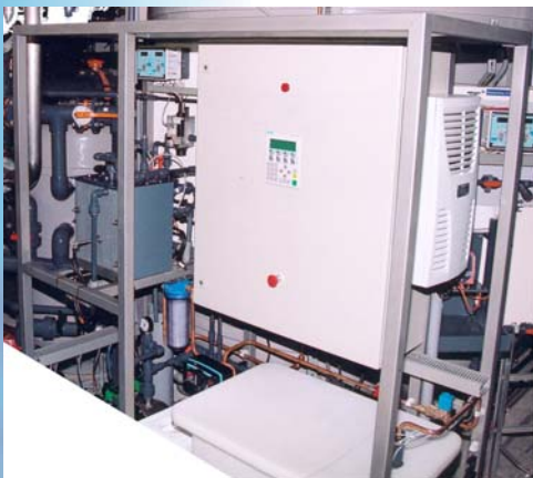
Steuerungs- und Kontrolleinheit mit eingebautem Kühlsystem
